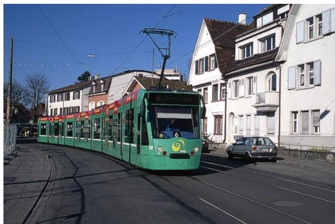
Bâle - Baslerstrasse - 09/02/2008 - Les motrices Combino se sont parfaitement bien accommodées des conditions classiques d'exploitation du réseau de Bâle. Très nerveuses et quoique offrant un roulement un peu dur, ces voitures circulent rapidement sur les voies banalisées du réseau dont la capacité de transport a été notablement augmentée
