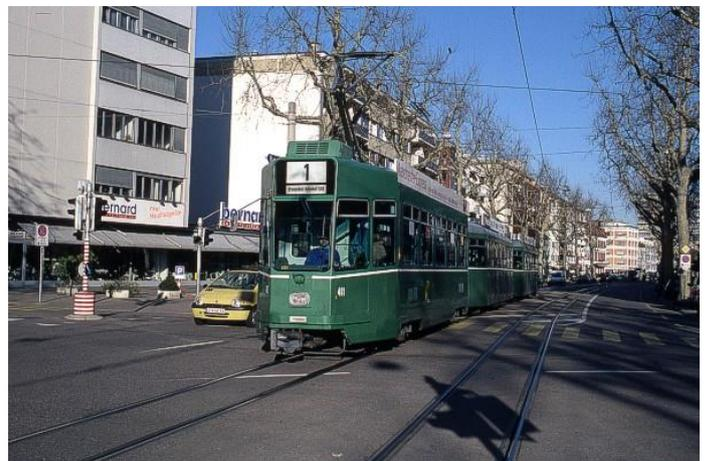
Bâle - Spalenring - 09/02/2008 - Les lignes 1 et 14 forment une espèce de circulaire intérieure en forme de tête de tulipe. Elle est principalement exploitée à l'aide de convoi de trois voitures, une motrice Be4/4 de la série 477 à 502, livrée en 1986-87 tractant deux remorques normalisées de 1967. Ce type de composition est typique du réseau bâlois
