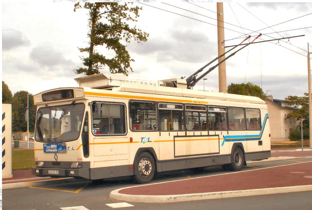
Le trolleybus ER 100 n° 404 avec perches télescopiques au terminus de la Cornue (ligne 5)
